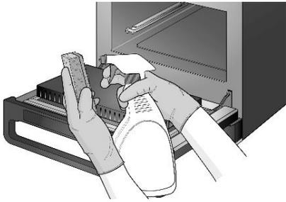
2. Распределите защитное химическое покрытие тонким слоем по всем внутренним поверхностям, избегая попадания на внутреннюю верхнюю поверхность (паровую пластину) и уплотнитель дверцы.
