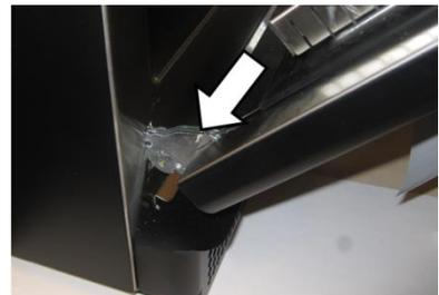
3. Закройте дверцу на два металлических штифта и затем освободите дверцу, потянув вверх и вперед. После этого дверцу следует полностью снять.
