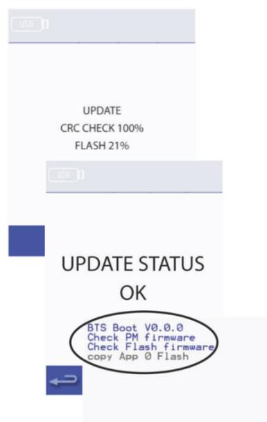
8. Файлы QTS, SRB и значков приложения будут автоматически загружены, при этом для каждого обновляемого файла будут выведены экраны индикации хода выполнения, состояния и подтверждения перезагрузки.
