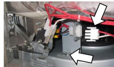
2. На левой стороне устройства отверните винт PZ2 и гайку M7, которые удерживают опорную пластину платы контроллера частоты вращения двигателя конвекционного вентилятора.
