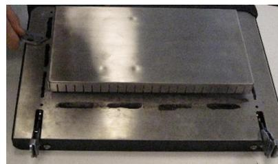
4. Нанесите герметик по периметру имеющейся уплотнительной поверхности дверцы. Убедитесь в том, что герметик нанесен на все четыре стороны.
