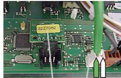
Убедитесь в том, что отрицательное (-) соединение (белое) и положительное (+) соединение термопары подсоединены правильно, в противном случае показания температуры в печи будут неправильными.
