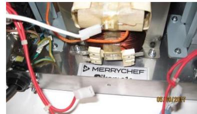
2. Отсоедините трансформатор(трансформаторы) от магнетрона(магнетронов), для этого отсоедините оранжевые кабели в месте их подсоединения к магнетрону(магнетронам).
