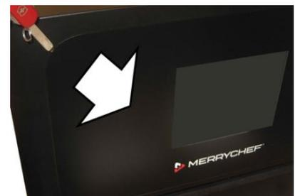
2. Клей необходимо удалить с устройства, используя очиститель на спиртовой основе, прежде чем установить сменную деталь.
