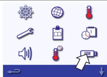
6. Нажмите значок USB «Передача микропрограммного обеспечения в печь» (Firmware to Oven).
