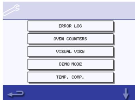
2. В число подробной информации входит количество нажатий экрана, циклов работы фильтра, циклов открывания дверцы, общая мощность печи, мощность магнетрона и нагревательного элемента по времени и температура в зоне систем управления в шкафу.
