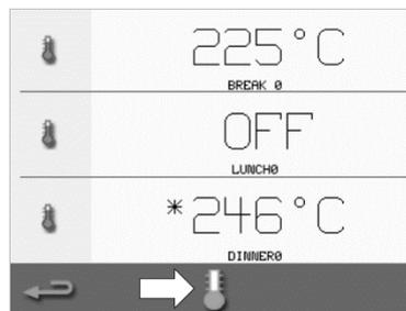
3. Будет отображен процесс охлаждения, который займет приблизительно 20 минут. Чтобы сократить время охлаждения, оставьте дверцу устройства приоткрытой во время процесса охлаждения.
