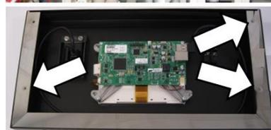
4. Отверните четыре фланцевых болта с шестигранными головками M5.5, чтобы снять QTS в сборе с передней панели.
