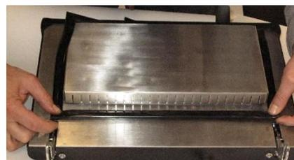
6. Нанесите герметик под уплотнитель дверцы и плотно прижмите его, чтобы герметично закрепить уплотнитель на дверце. Убедитесь в том, что он расположен прямо, и сотрите все излишки герметика.
